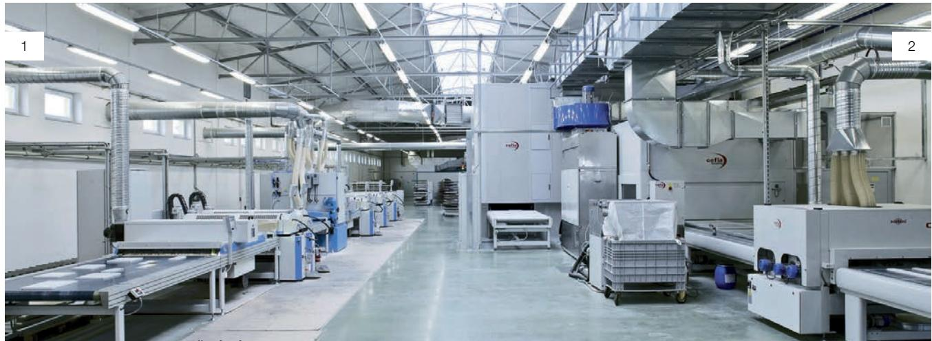
1) UV LINKA BÜRKLE NA PLOŠNÉ DÍLCE / BÜRKLE UV coating line for flat surface / Уф линия BÜRKLE для плоских частей
