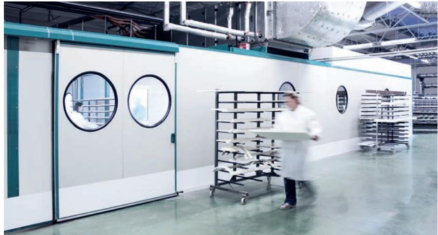
RUČNÍ PŘETLAKOVÁ LAKOVACÍ KABINA S VELKOKAPACITNÍ SUŠÁRNOU GIARDINA
